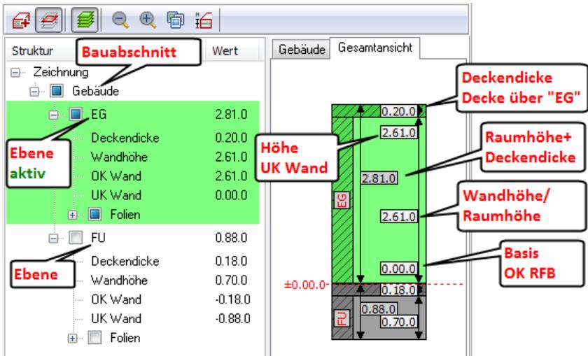
*Beispiel einer einfachen Ebenendefinition von Fundament und EG. Über die Kästchen vor der Ebenenbezeichnung lassen sich die zugehörigen Folien einer Ebene alle auf einmal ein- /ausschalten, ohne in die Folienverwaltung wechseln zu müssen, bzw. lassen sich Strukturzweige ein- /ausfahren.*
