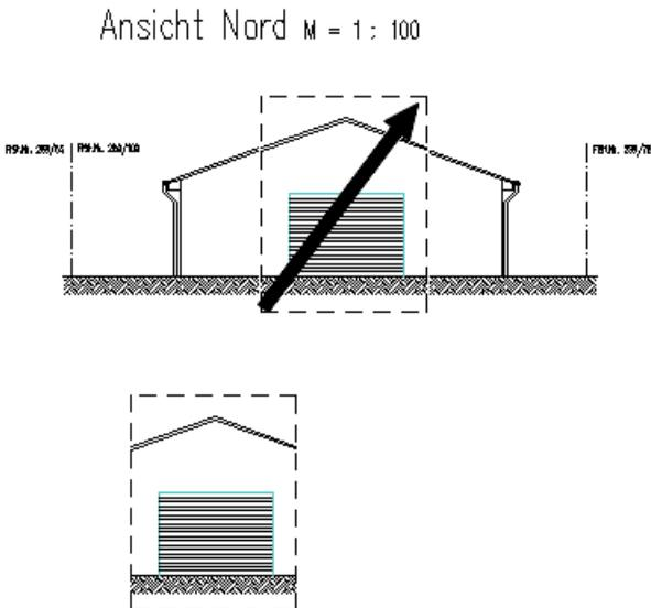
Planausschnitt wird über ein Rechteck aufgespannt. Als Ergebnis bleibt der Inhalt im Cliprahmen. Elemente die außerhalb des Cliprahmens liegen werden ausgeblendet, Elemente die teilweise im Cliprahmen liegen werden am Rahmen optisch abgeschnitten. Anschließend wird der Planausschnitt als Plan in der Planliste abgelegt, wobei zuvor ein Name für den Plan in der Eingabeleiste vergeben werden kann (muss).
