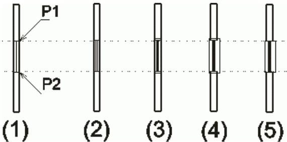
Darstellung von Fenstern im Grundriss bei unterschiedlichen Schalterstellungen.
