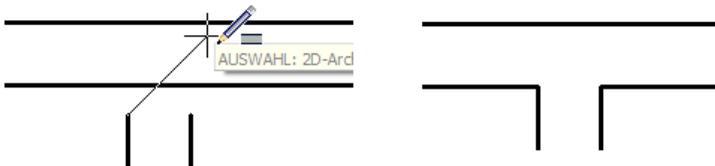
*Wandanschluss der anzuschließenden Wand wird automatisch hergestellt.*
