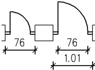
Eine Tür wird mit "76cm" eingegeben. Links: "Rohbau" eingeschaltet, die Pfosten liegen innerhalb des Rohbaumaßes der Eingabe. Rechts: "Rohbau" ausgeschaltet, die Pfosten liegen außerhalb des Maßes über das die Tür eingegeben wurde.
