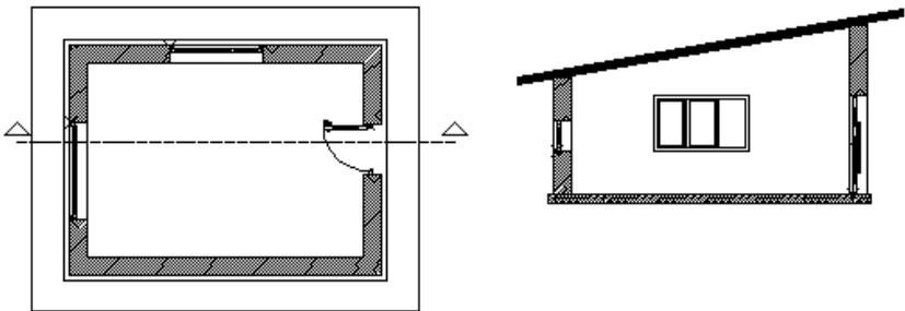
*Beispiel: Vertikales Schnittergebnis einer Schnittlinie (mit "Ansicht").
