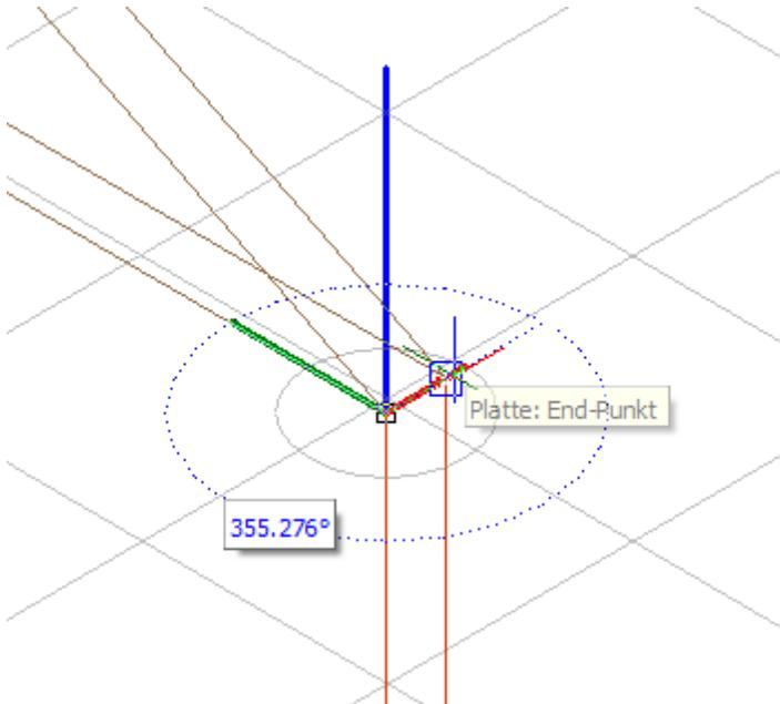
4. Fangen Sie sich auf der äußeren Spitze des Giebels, um die **Y-Achse** zu fixieren.
