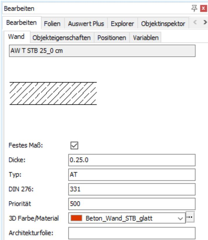
*Dialogfenster eines geöffneten Architekturbauteils im Explorer-Fenster. Je nach Objekt variieren die Daten im Fenster. Die Daten müssen auf die zeichnerische Darstellung des Objekts abgestimmt werden, z. B. bei Wanddicken. Die Option "Festes Maß" besagt, dass das Objekt bei Auswahl und Zeichnen einen festen Wert hat, so lässt sich eine "feste" 25cm dicke Wand nicht als 11,5er Wand darstellen.*
