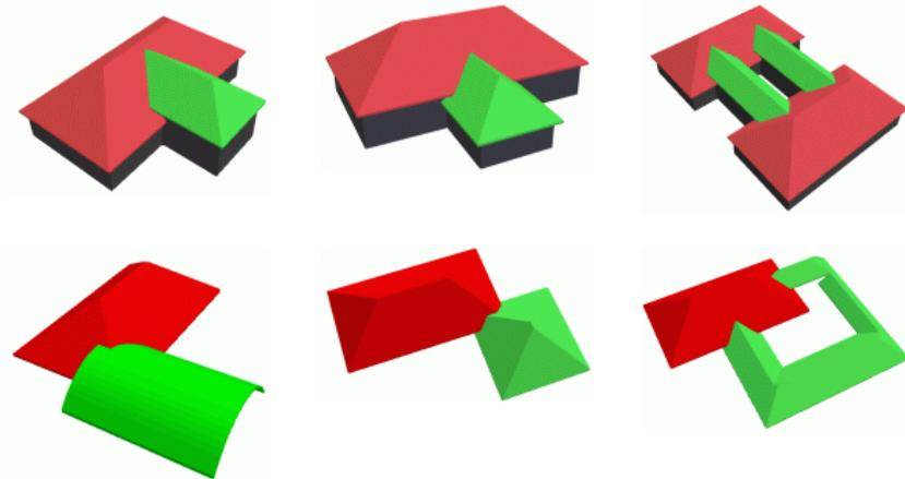
*Nebendach* ermöglicht u. a. eine Überschneidungen von Dachüberständen (linke und mittlere Spalte) sowie komplexe Dachformen (rechte Spalte)
