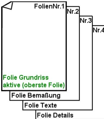
*Bild: Beispiel eines kleinen Folienstapels, bestehend aus vier Folien mit Namen "Grundriss", "Bemaßung", "Texte", "Details". Die Namen sollten dem Inhalt möglichst treffend und kurz umschreiben. Die oberste Folie ist die "aktive" Folie.*
