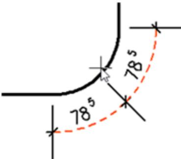
*Im Beispiel wird die Mitte des Bogens als Einfügepunkt eingefangen, entsprechend wird das vorhandene Bogenmaß aufgeteilt.*
