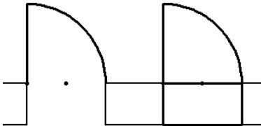
Eingeschaltet wird die Wand im Bereich der Öffnung aufgetrennt (links). Ausgeschaltet bleibt die Wand unberührt.
