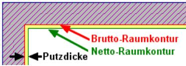
Die Differenz zwischen Brutto- und Nettoraumkontur stellt die Putzdicke dar. (Je nach Bild- oder Druckmaßstab ist diese optisch schwer zu erkennen.)
