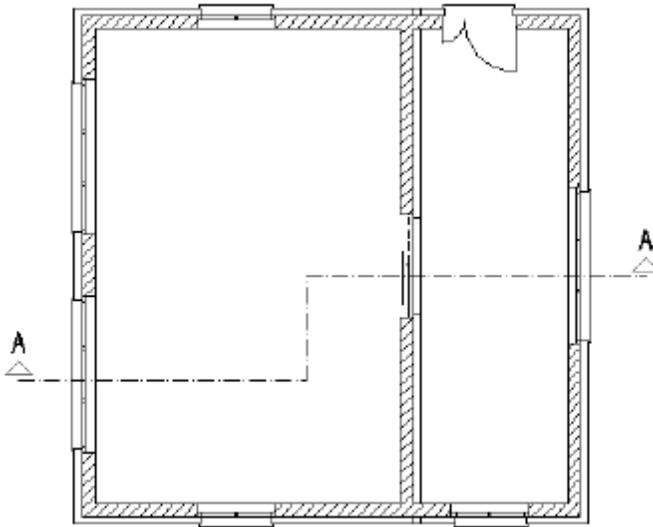
Entlang der eingegebenen polygonalen Schnittlinie wird eine *Schnittabwicklung* erstellt. Als *Abwicklung* wird das Ausbreiten der Ansichts- bzw. Schnittfläche eines Körpers in die Zeichenebene bezeichnet. In orthogonaler Blickrichtung, von jedem Segment der versetzten Schnittlinie aus, werden alle geschnittenen bzw. sich in der Blicktiefe befindlichen Elemente dargestellt.
