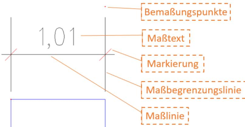
Definiert wird eine Bemaßung grundsätzlich durch zwei Punkte (Bemaßungspunkte), die entweder mit der Maus identifiziert werden oder von der Ausdehnung eines selektierten zu bemaßenden Elementes übernommen werden, und einen Absatzpunkt, der angibt, wo die Maßkette positioniert sein soll.
