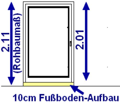
Die Oberkante des Fertig-Fußbodens wird nach Identifizieren eine Öffnung mit der Funktion Ident ([Shift] + mittlere Maustaste) im Objektinspektor im Dialog angezeigt. Bei der Bemaßung besteht später die Möglichkeit auszuwählen, ob sich die Höhenmaße (BRH, Höhe) auf den Rohfußboden (RFB) oder den Fertigfußboden (FFB) beziehen sollen.
