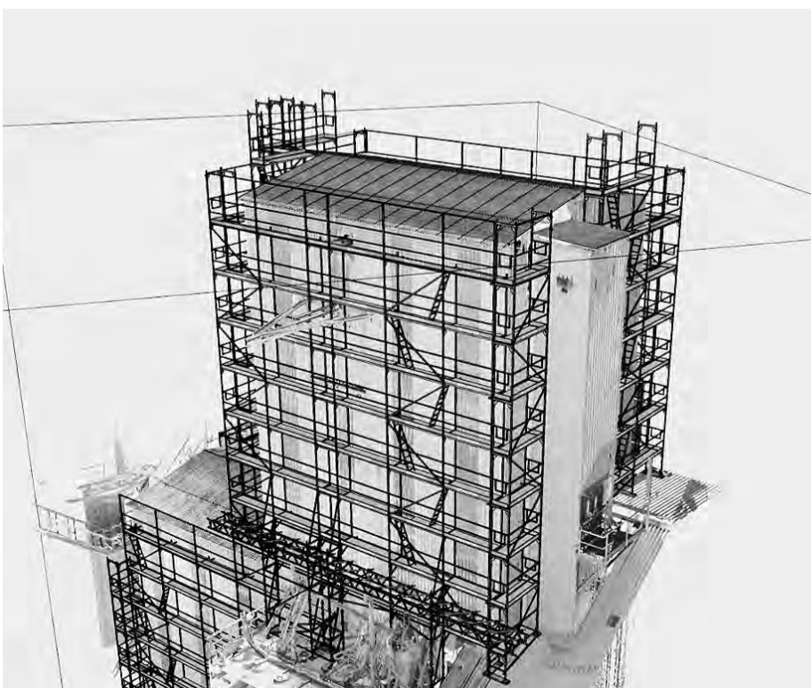
Gebäude können mit einem Punktwolken-scanner erfasst und in scaffmax nachgebaut und digital eingerüstet werden. Die Firma Schäfer Gerüstbau nutzt diese Möglichkeit bereits. ABB.: GERÜSTBAU SCHÄFER
