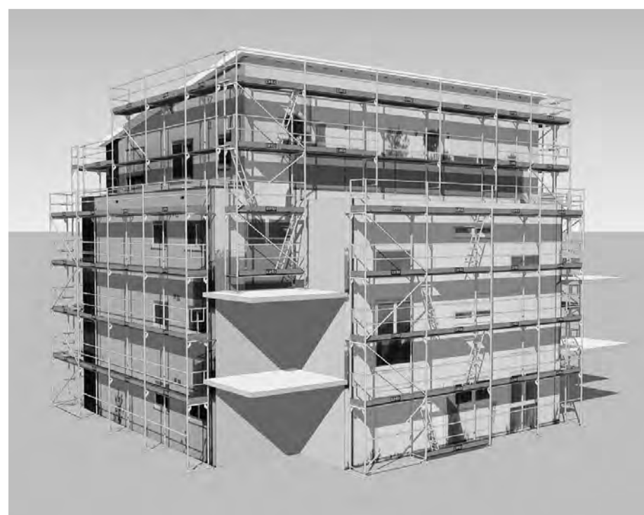
Modell eines mit scaffmax eingerüsteten Gebäudes.
