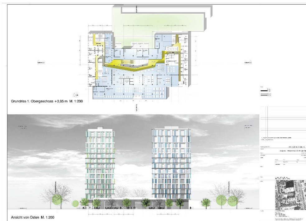
Abbildung aus Projekt 1.: Grundriss vom 1. OG und Modellansicht auf Wohn- und Geschäftshaus „Blue Tower“ in Frankfurt am Main (mit SPIRIT erstellt) Urheber: pWA/planwerkstatt.architekten, Furth im Wald
